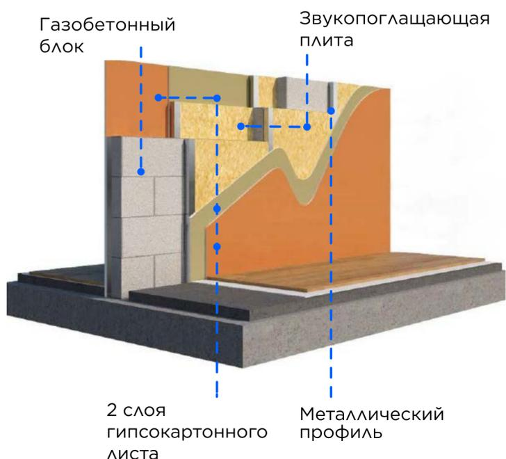
Acoustic Pro — система, разработанная в сотрудничестве с экспертами из Корейской Республики специально для VI Group, представляет собой многослойную конструкцию, состоящую из двух слоев гипсокартона, минераловатной плиты и газоблокато толщиной 100 мм содной стороны, а с другой стороны — минераловатной плиты и двух слоев гипсокартона.
