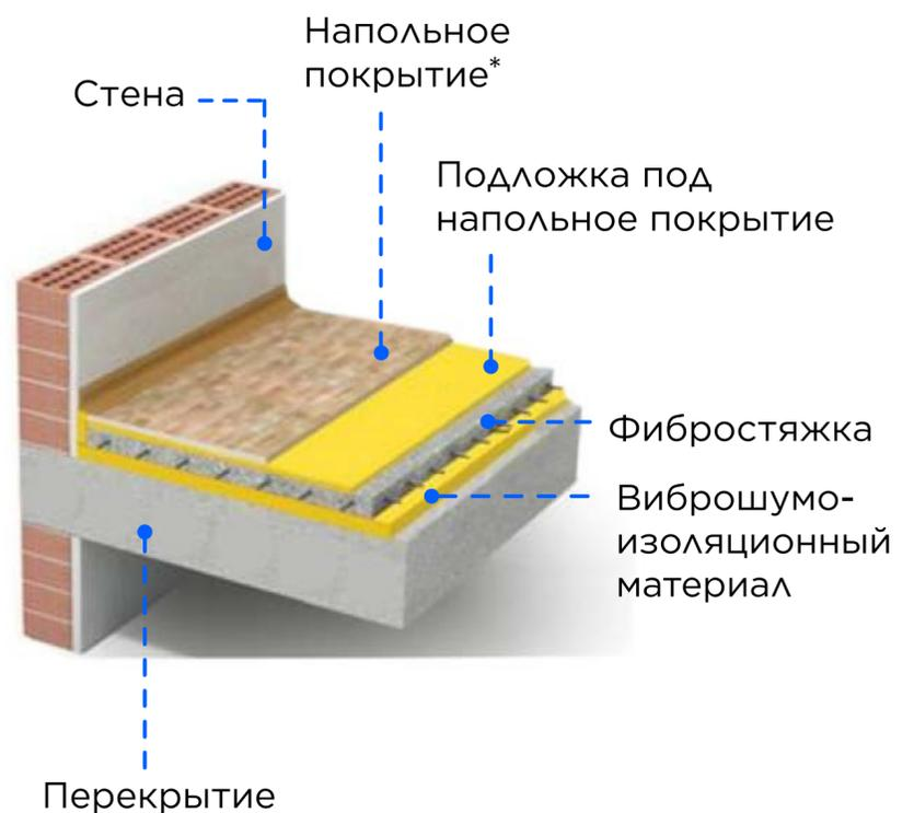
«Плавающий пол» блокирует распространение ударного шума
