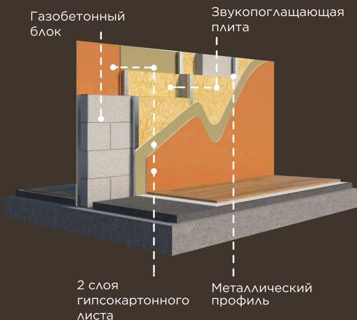
Acoustic Pro — система, разработанная в сотрудничестве с экспертами из Корейской Республики специально для VI Group, представляет собой многослойную конструкцию, состоящую из двух слоев гипсокартона, минераловатной плиты и газоблока толщиной 100 мм с одной стороны, а с другой стороны — минераловатной плиты и двух слоев гипсокартона.
