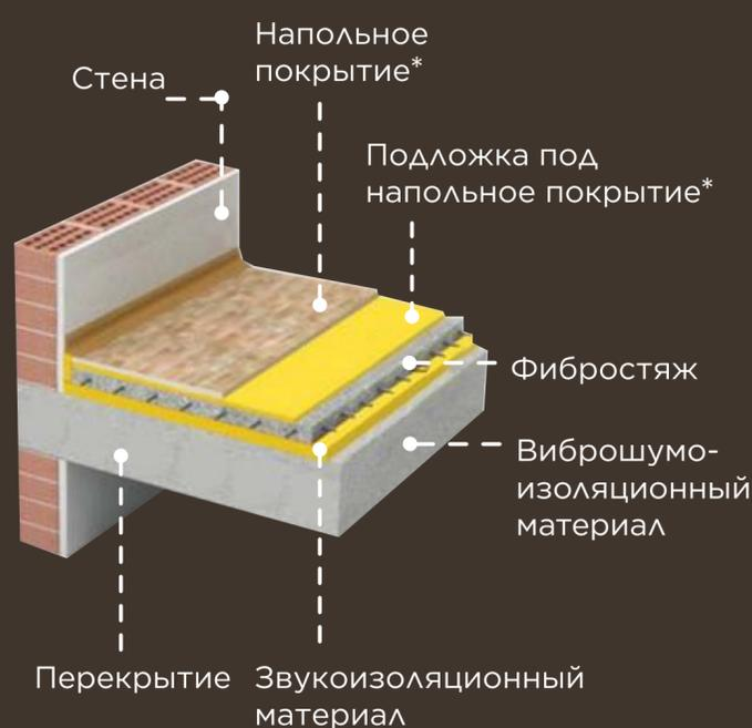
«Плавающий пол» блокирует распространение ударного шума
