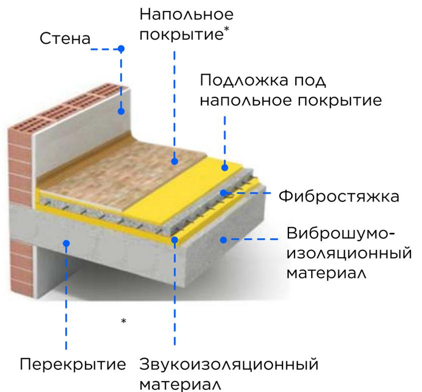
«Плавающий пол» блокирует распространение ударного шума
