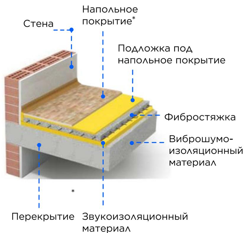
«Плавающий пол» блокирует распространение ударного шума
