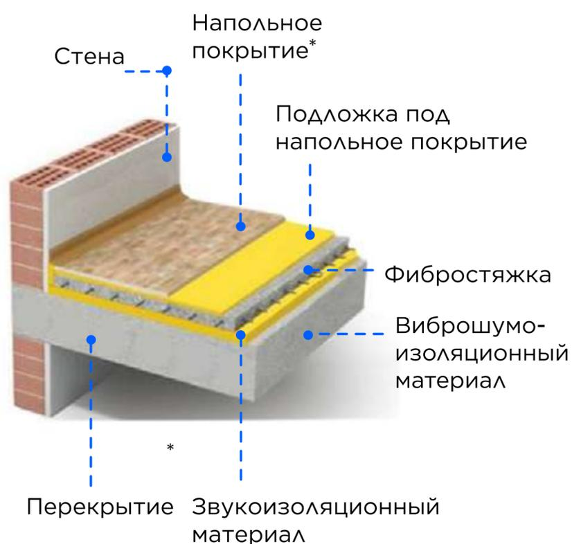
«Плавающий пол» блокирует распространение ударного шума
