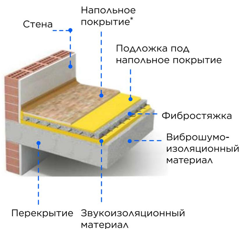
«Плавающий пол» блокирует распространение ударного шума
