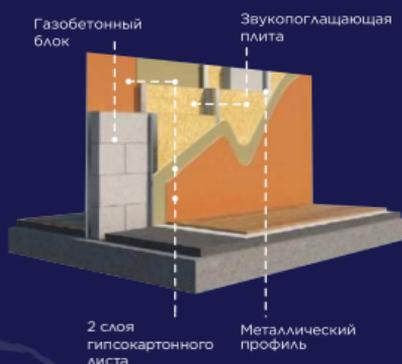
Acoustic Pro — система, разработанная в сотрудничестве с экспертами из Республики Корея специально для VI Group, представляет собой многослойную конструкцию, состоящую из двух слоев гипсокартона, минераловатной плиты и газоблока толщиной 100 мм с одной стороны, а с другой стороны — минераловатной плиты и двух слоев гипсокартона.
