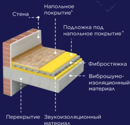
«Плавающий пол» блокирует распространение ударного шума
